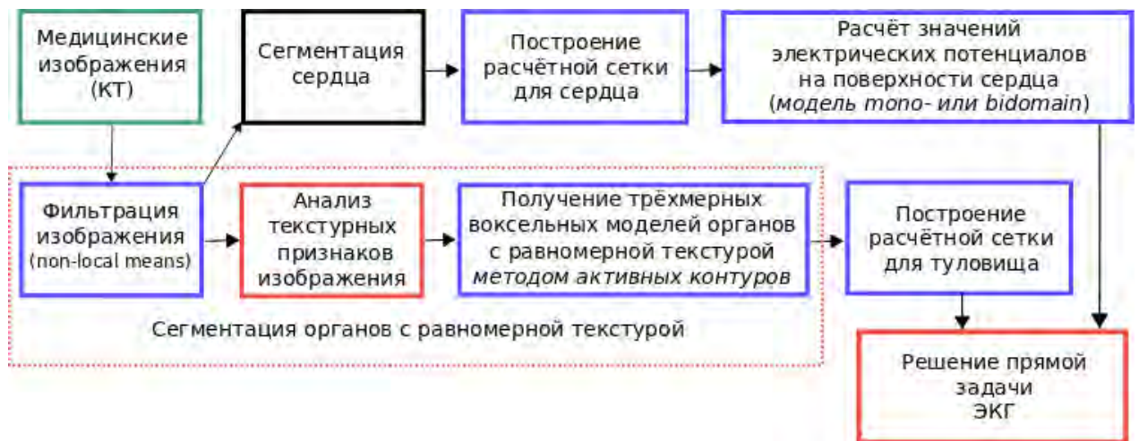
Рисунок 4.1 — Схематичное изображение алгоритмической цепочки для математического моделирования ЭКГ с учетом индивидуальных анатомических особенностей конкретных пациентов
