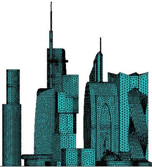
Поверхностная сетка расчетной модели и расчетная область (ANSYS)
