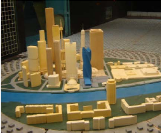
Модель для аэродинамических испытаний в АДТ (ВМТ)
