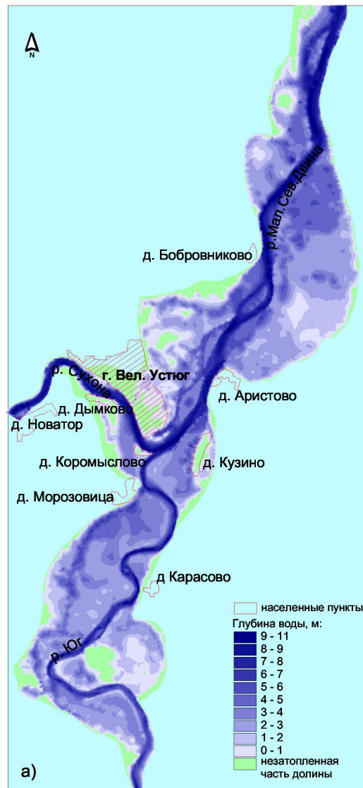
Глубины (а), отметки водной поверхности (б) и скорости течения (в) при прохождении по рекам Сухоне и Югу максимальных расходов 1% обеспеченности
