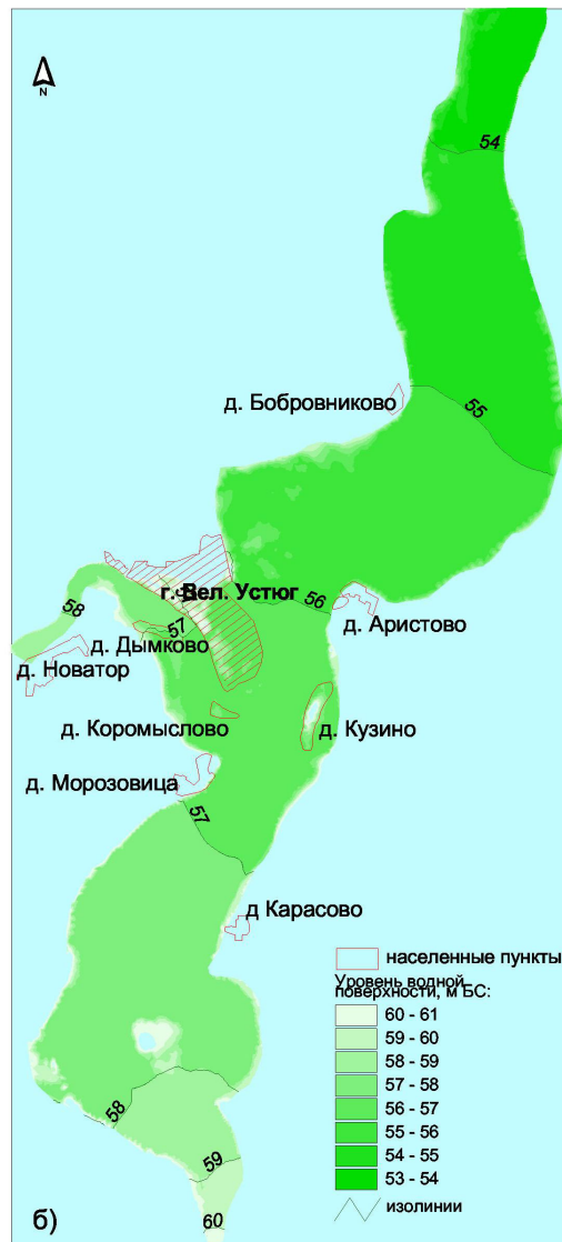
Глубины (а), отметки водной поверхности (б) и скорости течения (в) при прохождении по рекам Сухоне и Югу максимальных расходов 1% обеспеченности
