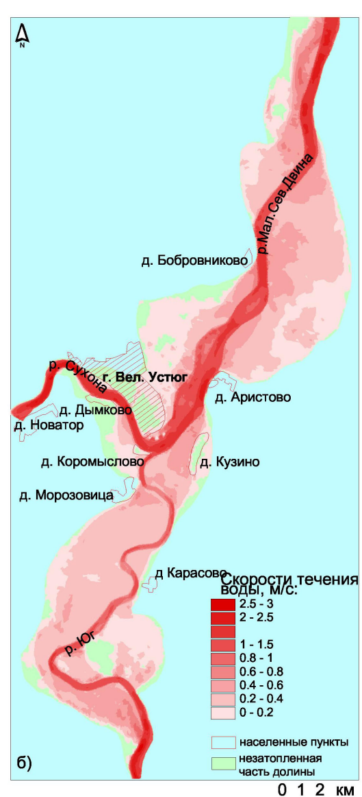
Глубины (а), отметки водной поверхности (б) и скорости течения (в) при прохождении по рекам Сухоне и Югу максимальных расходов 1% обеспеченности
